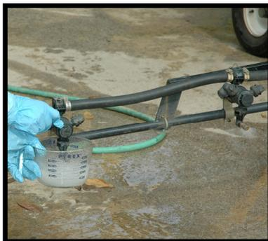
Fig. 111. Determine la descarga de cada boquilla por minuto y reemplace aquellas que difieran por más de 5%.
