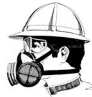
Aplicador usando sombrero impermeable de ala ancha, anteojos y respirador de cartucho químico
