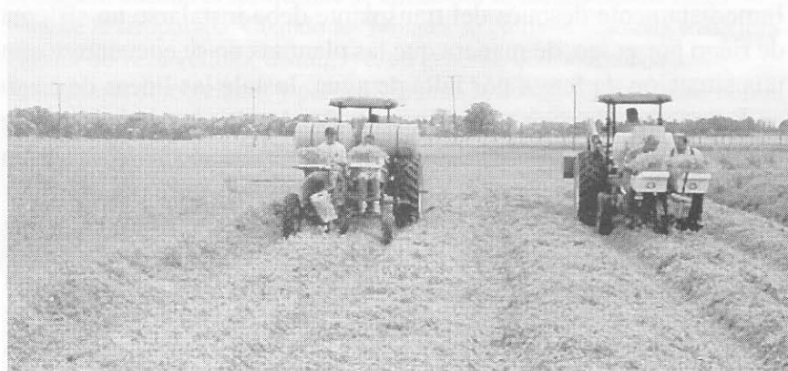
Figura 4. Transplante de tomates bajo una cobertura vegetal muerta de veza vellosa usando transplantadores sin arado.
