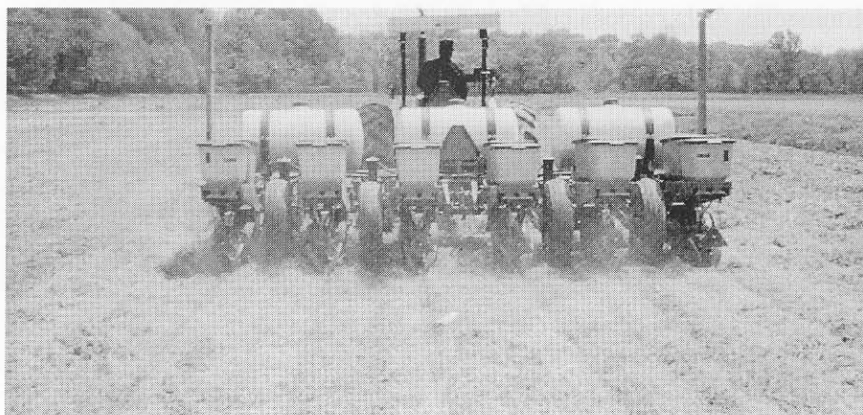
Figura 10. Una sembradora de seis surcos sin arados plantando habichuelas tiernas.
